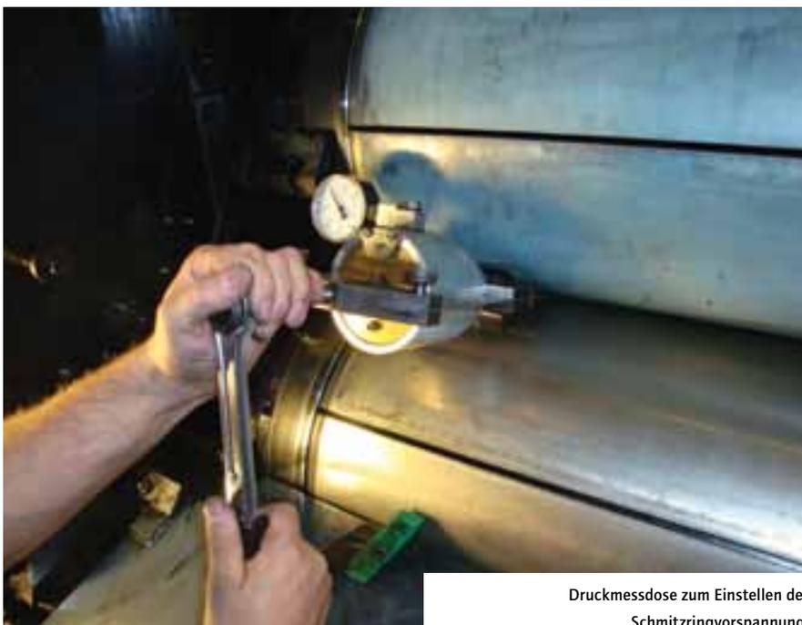
Druckmessdose zum Einstellen der Schmitzringvorspannung.
